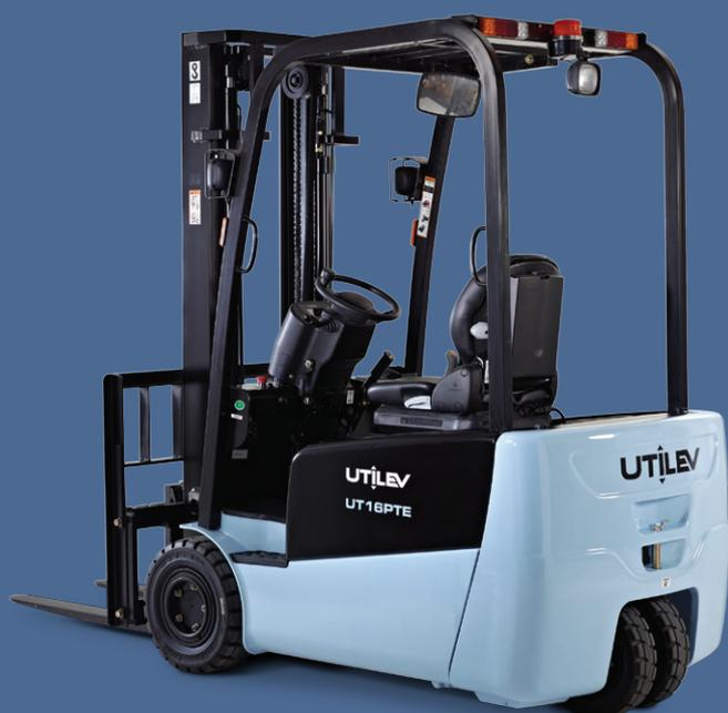
Grâce à leur petit rayon de braquage extérieur (585 mm) et à l'efficacité de leur batterie de 48 V, les modèles de la gamme PTE sont idéalement adaptés aux applications en intérieur. Ce chariot est couramment utilisé dans les applications suivantes :
